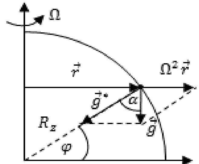
1. Izračunajte kut između gravitacijske sile i sile teže na površini Zemlje kao funkciju geografske širine. Pretpostavite da je radijus Zemlje konstantan. Izračunajte taj kut za čest koja miruje na površini Zemlje na  $\varphi = 30^\circ, 45^\circ, 60^\circ, 90^\circ$ .
