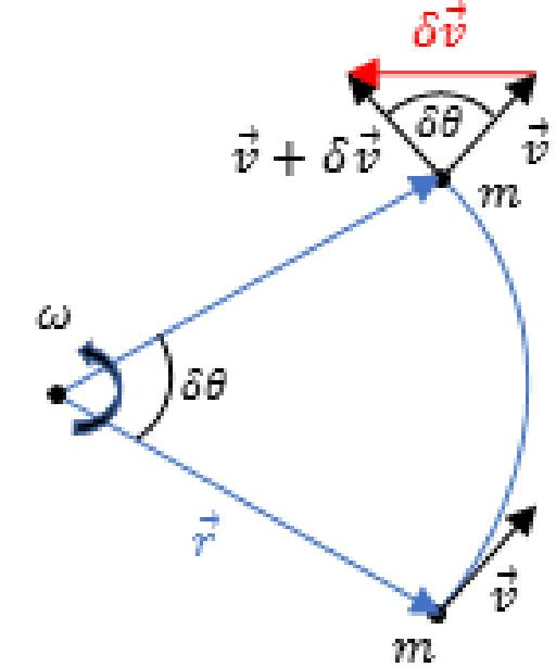
Iz sustava koji rotira zajedno s promatranom masom  $m$  vidimo da je masa stacionarna, ali na tu masu djeluje sile u smjeru osi rotacije. Moramo dodati prividnu силу kako bi tijelo bilo u ravnoteži, a tu силу zovemo centrifugalna sila. Dakle, u sustavu koji rotira s masom  $m$  vidimo stacionarnu masu, a centripetalna sila uravnotežena je centrifugalom.
