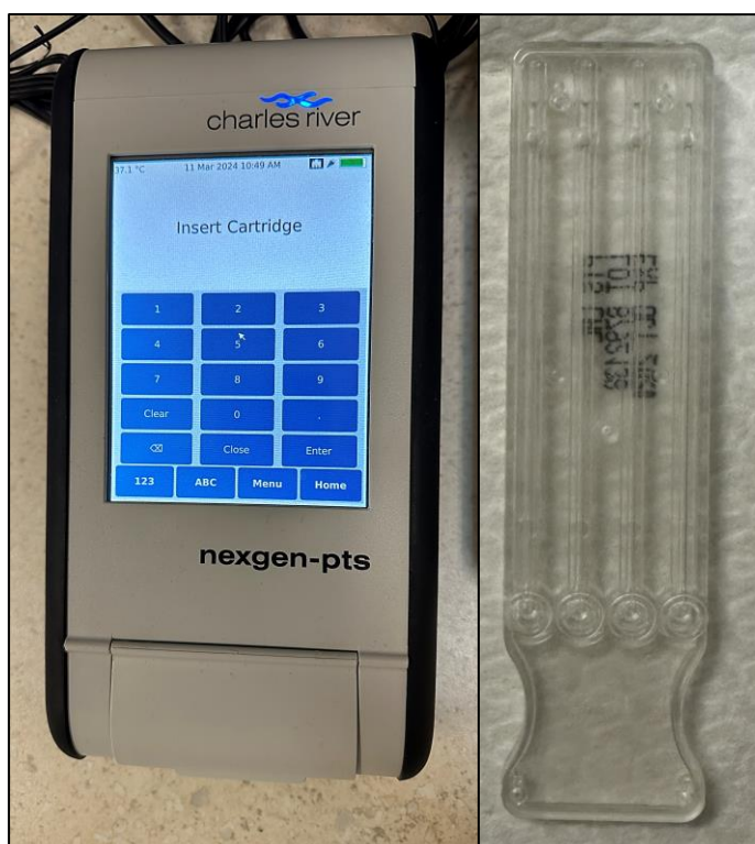
Slika 10. Uređaj za bakterijsko određivanje endotoksina i uložak (Klinički zavod za nuklearnu medicinu i zaštitu od zračenja, KBC Zagreb)
