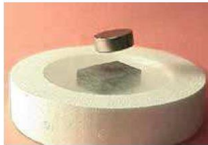
Primjer levitiranja malog magneta iznad suravodiča
