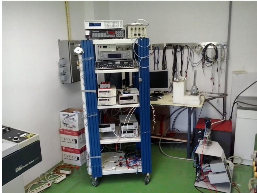
Sustav za transportna mjerenja. Sastoji se od sustava za hlađenje (crycooler), mjernih instrumenata i vakuumnog sustava. Crycoolerom se može vrlo brzo ohladiti uzorak do otprilike 10K.
