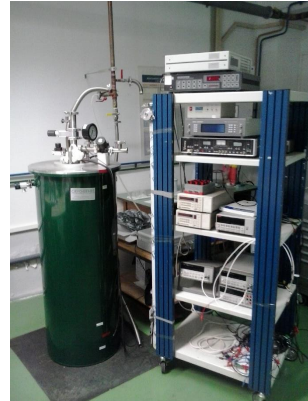
Kriostat za karakterizaciju na niskim temperaturama (do 1.7K).
