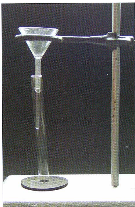
Slika 3a. Fotografija aparature za filtriranje s pomoću Willstätterova čavlića.
