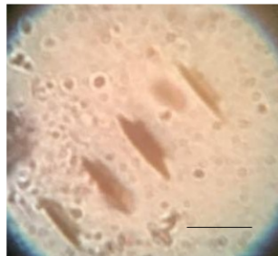
(c) Četiri linije napravljene skeniranjem snopa u mikroprobi. Linije su dimenzija 10\mu m \times 25\mu m u dozama redom: 1.76mC , 3.6mC , 7.2mC , 14.2mC .
