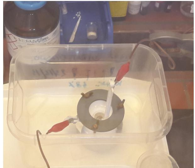
**Slika 3.5:** Eksperimentalni postav u fazi jetkanja. +pol strujnog izvora spojen je na platinastu žicu koja se na donjem dijelu teflonskog držača plete u mrežicu. Elektroda je uronjena u HF kiselinu koja ispunja pola teflonske posudice. Na dnu je izložen središnji dio uzorka. Uzorak je u ohmskom kontaktu s aluminijskom folijom koja je spojena na -pol izvora. Slikano kroz prozor digestora zbog isparavanja otrovnog HF-a.
