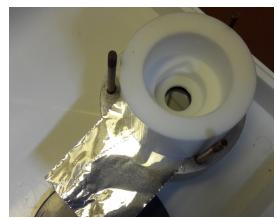
(b) Uzorak služi kao poklopac za otvor u dnu teflonske posudice; brtva je polimerni prsten otporan na HF. Koristi se  $20 \text{ mL}$  elektrolita.
