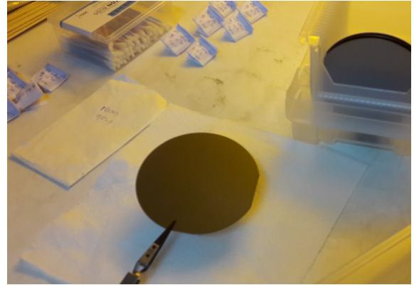
**Slika 3.1:** Pločica p-tipa silicija otpornosti  $0.5 - 1 \Omega cm$  korištena za jetkanje.
