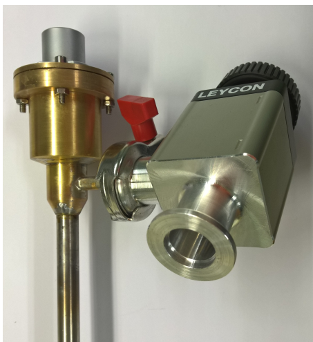
Slika 6: Dio probe s vakuumskim izlazom i konektorom.
