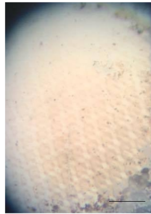
(b) Uzorak napravljen bakrenom mrežicom dimenzije 25\mu m \times 25\mu m .
