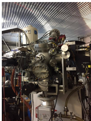
Slika 3: Mikroproba u kojoj je napravljeno ozračivanje dijamanta, u mikroprobu se može uvesti snop iz oba akceleratora, no mi smo izabrali Van de Graaff Tandem zbog mogućnosti stvaranja snopa iona niske energije.
