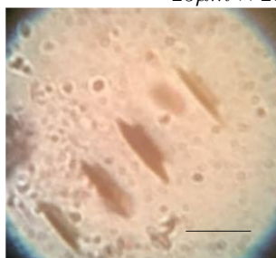
(c) Četiri linije napravljene skeniranjem snopa u mikroprobi. linije su dimenzija 10\mu m \times 25\mu m .
