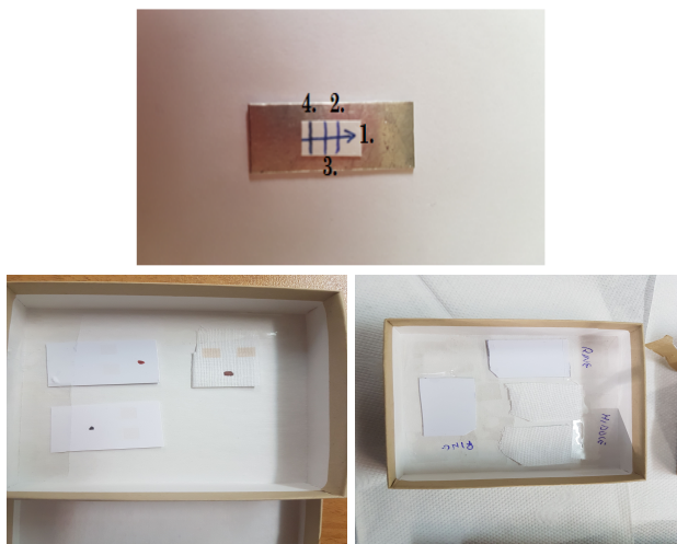
Slika 8: Prikaz uzoraka prije nego što su postavljeni u komoricu za mjerenje. Gore: uzorak tinti na papiru. Dolje lijevo: Uzorci krvi na papiru, tkanini i plastici. Dolje desno: Uzorci otiska prsta na papiru i tkanini.
