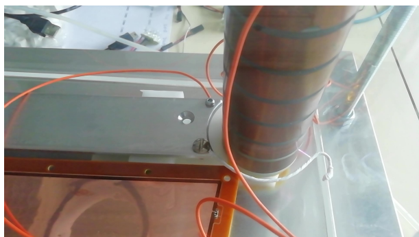
Slika 13. Napon je na GEM-u i "skirt"-u, a šipka je uzemljena, udaljenost šipka-žica \approx 6.5 mm, izboj na 5.4 kV.
