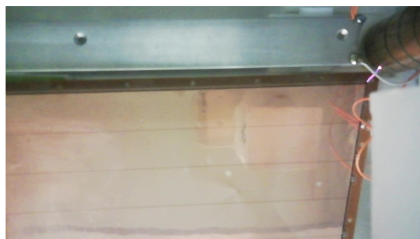
Slika 16. Napon je na šipci i "skirt"-u, a GEM je uzemljen, udaljenost GEM-šipka \approx 13 mm, izboj na 6.5 kV.
