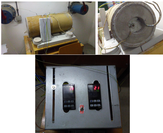
Slika 3: Fotografije peći i kontrolnog sklopovlja. Čepovi korišteni za zatvaranje komore vidljivi su ispred peći.
