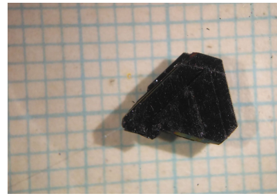
Slika 4: Primjer kristala \text{NbS}_2 snimljenog pod mikroskopom. Ispod kristala vidljiv je milimetarski papir. Prikazani kristal nije kalan kako bi bio vidljiv u obliku u kojem je nastao. Ovakva veličina uzoraka vrlo je pogodna za daljnja istraživanja.
