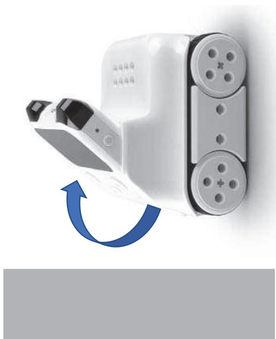
⌚ **Savjet:** Prije korištenja potrebno je napraviti kalibraciju senzora kako bi Codey Rocky s lakoćom uočio prepreku.
