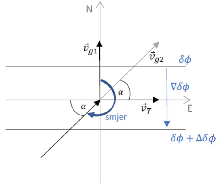
8. Nađite smjer i brzinu geostrofičkog vjetra na 500 hPa, ako je vjetar na 1000 hPa južni iznosa  $10 \text{ m s}^{-1}$ . Izohipse  $RT_{1000}^{500}$  paralelne su s geografskim paralelama. Udaljenost izohipsi na karti je 1.5 cm, a mjerilo karte je  $1: 1.5 \cdot 10^7$ . Izohipse se crtaju svakih 40 gpm, a geopotencijal raste prema jugu. Geografska širina je  $55^\circ\text{N}$ .
