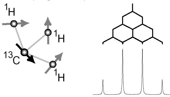
Spektri se mogu pojednostavniti rasprezanjem
