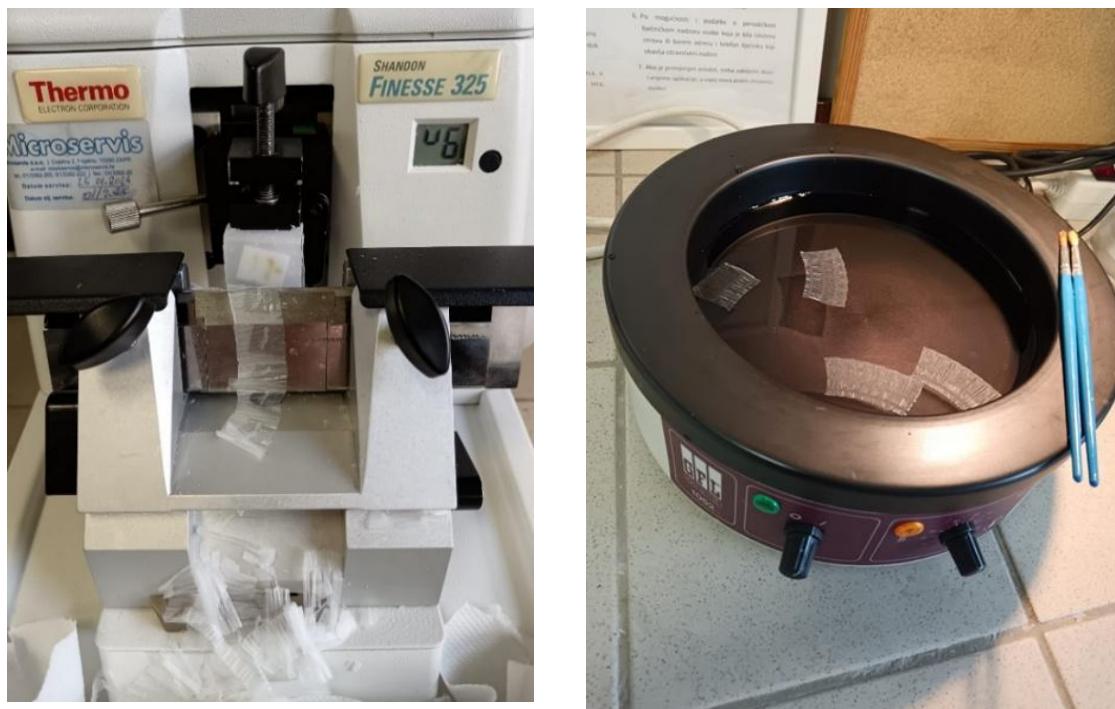
Slika 18. Rezanje tkiva tankog crijeva uklopljenog u parafinski blok na rotacijskom mikrotomu (lijevi panel); izravnavanje histoloških rezova na vodenoj kupelji (desni panel) (foto Brižić 2024.)
