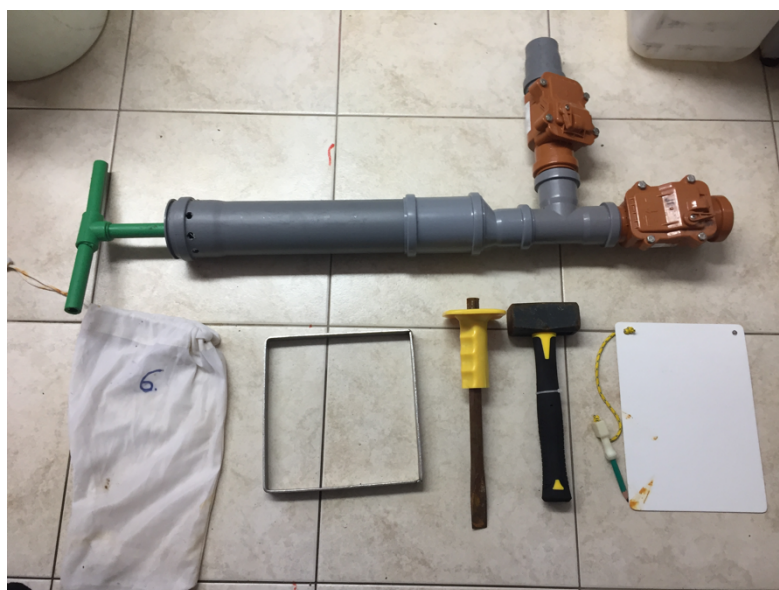
Slika 2.2. Ručni usisivač (MANOSS) (Chatzigeorgiou i sur., 2012), ploča za pisanje, čekić, dlijeto, metalni okvir površine 400 cm 2 te vreća za sakupljanje uzoraka.
