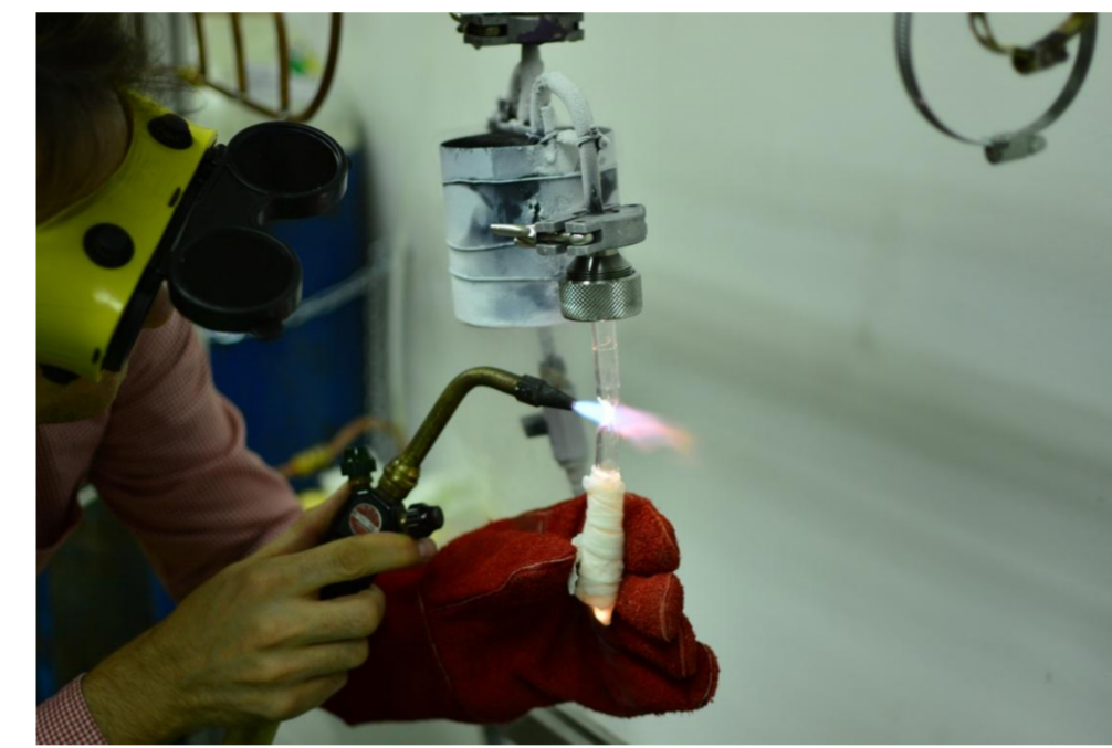
Zataljivanje kvarcne cijevčice u ampulu.
