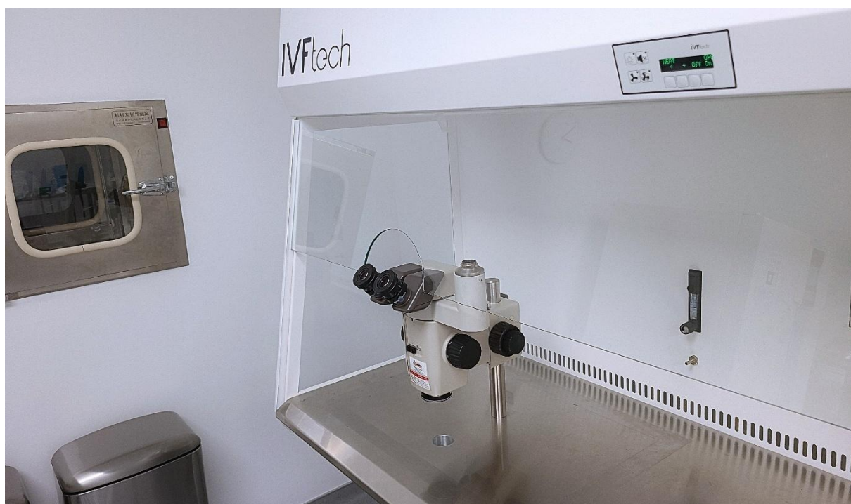
Slika 18. Besprašna komora IVFtech Sterile 180cm s trinokularnim stereomikroskopom Nikon SMZ-U
