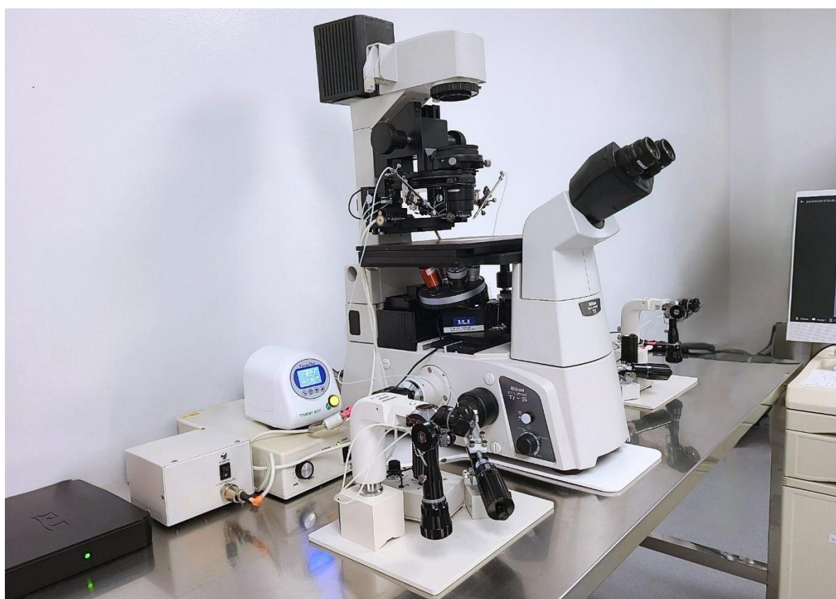
Slika 20. Invertni mikroskop Nikon Eclipse Ti-S opremljen s kamerom Watec WAT-221S, grijanom pločom Tokai Hit Thermo Plate, laserom Research Instruments Saturn Laser System, i sustavom za mikromanipulaciju Nikon Narishige NT-88-V3
