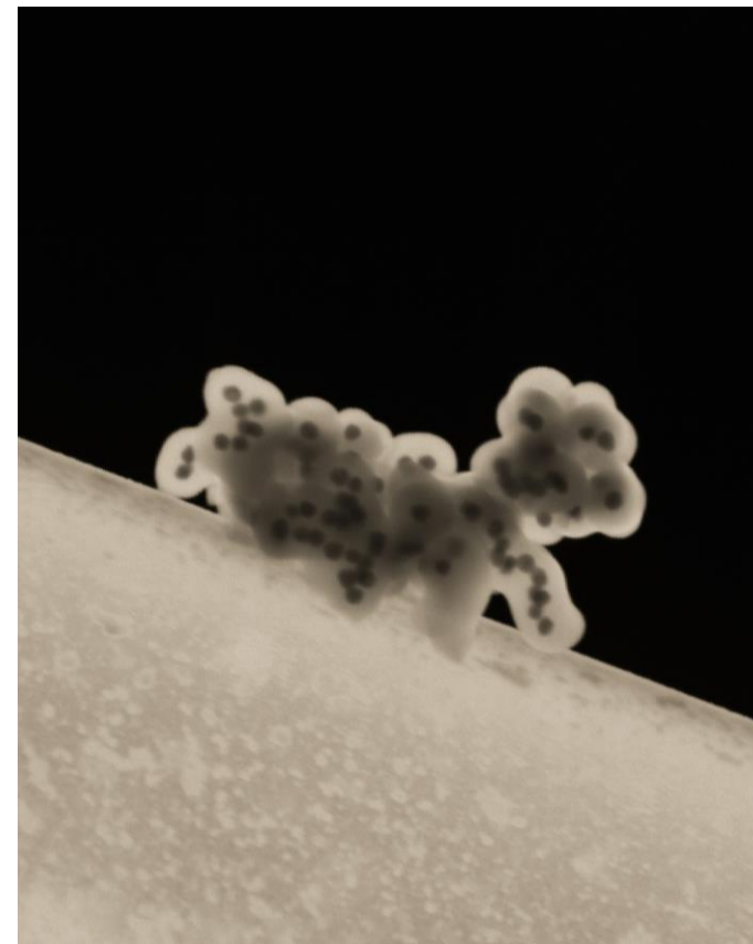
Struktura jezgra-omotač (engl. core-shell ) sastavljena od nanočestica srebra (crna jezgra) i silicijeva dioksida (svijetli omotač).
