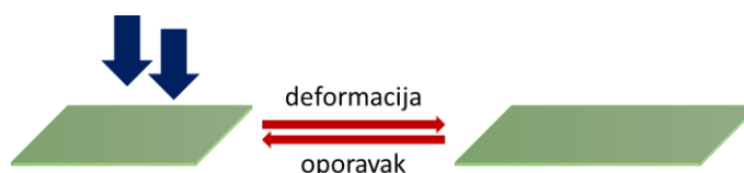
Slika 1. Primjer istezanja rezistivnog senzora uslijed primjene vanjske mehaničke sile te povratka u prvobitno stanje nakon uklanjanja vanjskog opterećenja.
