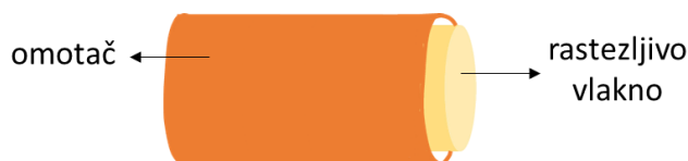
Slika 3. Optički senzor u tipičnom core-cladding obliku: valjkasta jezgra od rastezljivog materijala obložena omotačem koji sadrži svjetlosni odašiljač i fotodetektor.
