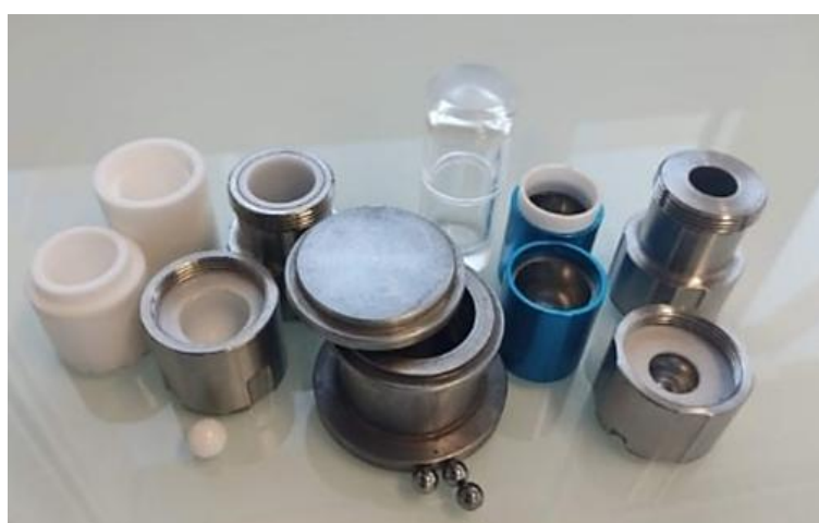
Slika 1. Kuglice i posude za mljevenje izrađene od različitih materijala. (O. Bento et al. , 2022) 11
