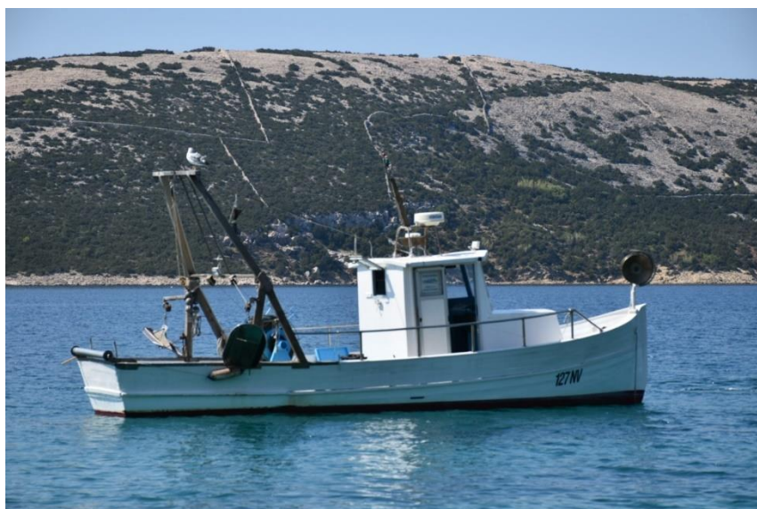
Slika 3.2.2. Ribarsko plovilo s kojim se vršio ribolov pridnom povlačnom mrežom kočom.
