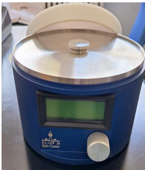
Slika 32. Uređaj za nanošenje na rotirajuću podlogu.
