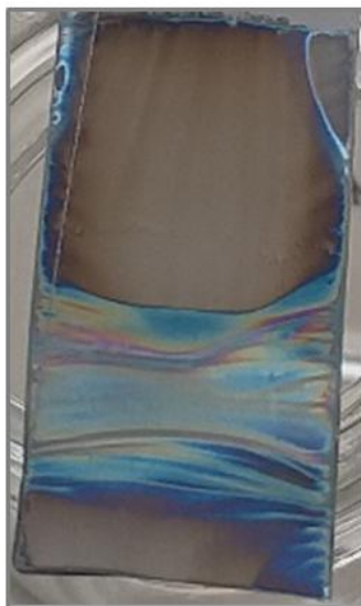
Slika 53. Optička snimka tankog filma [\text{CoCl}_3(\text{Cn})] na Si(100) veličine 1 \times 2 cm.
