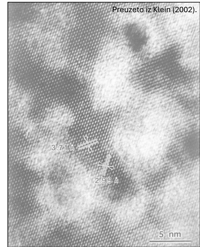
Struktura olivina s metamiktne domenama. Dobiveno pomoću HRTEM-a.
