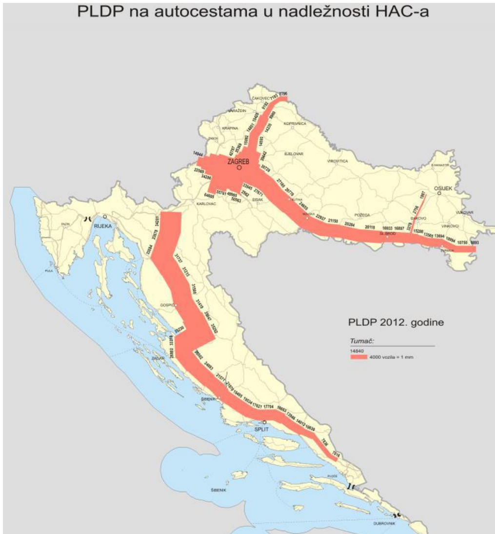
Sl. 25. Prosječni ljetni dnevni promet na autocestama u nadležnosti HAC-a Izvor : http://www.hac.hr/hr/promet-i-sigurnost/promet/brojanje-prometa/pldp/
