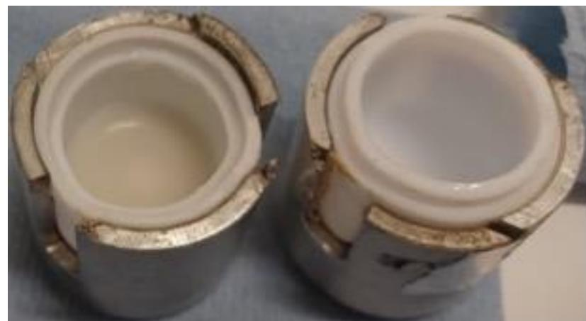
**Slika D5.** Posudice za mljevenje korištene za *in situ* PXRD mjerena. Umetak je izrađen od teflona ili PFA, a vanjska čahura od aluminija. U vanjskoj su čahuri izrezani prozori kako bi se omogućio prolaz sinkrotronske zrake kroz posudicu.
