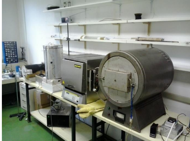
Peći. Homogenizacija materijala i rast kristala dešava se u pećima. Radna temperatura peći ide do 1300 °C.
