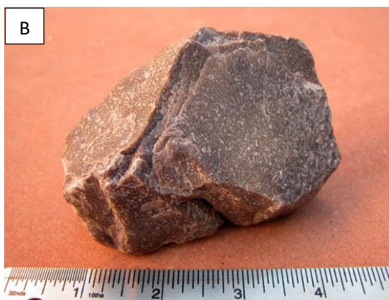
Sl. 52 A) Mramor – stijena granoblastične strukture i homogene teksture; B) kvarcit, homogena stijena granoblastične strukture
