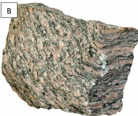
Sl. 51 A) tinjčev škriljavec s granatima (kuglasta zrna); B) gnajs s jasno vidljivom trakastom teksturom koja se očituje u izmjeni leukokratskih i melanokratskih minerala
