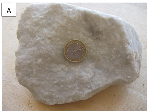
Sl. 52 A) Mramor – stijena granoblastične strukture i homogene teksture; B) kvarcit, homogena stijena granoblastične strukture
