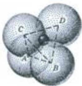
Sl. 15 Osnovna strukturna jedinica silikata, [\text{SiO}_4]^{4-} tetraedar
