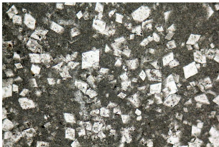
Sl. 44 Djelomično dolomitizirani vapnenac. Primjer kasnodijagenetske dolomitizacije s euhedralnim (idiomorfnim) kristalićima dolomita. (duljina slike 7mm)
