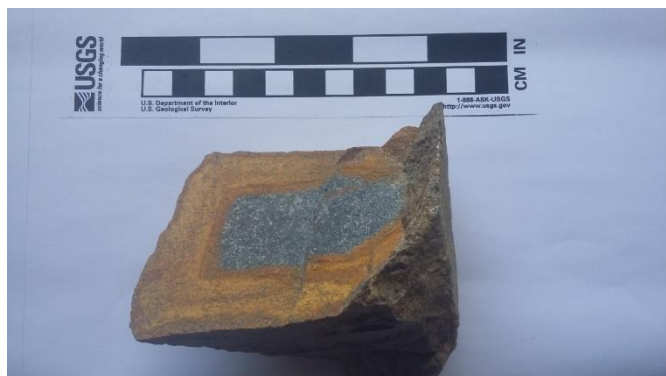
Sl. 25 Na slici se jasno razlikuju rubni, oksidacijom izmijenjeni dio uzorka (žućkasto-smeđa boja) i svježi, neizmijenjeni tamno sivi, središnji dio uzorka.
