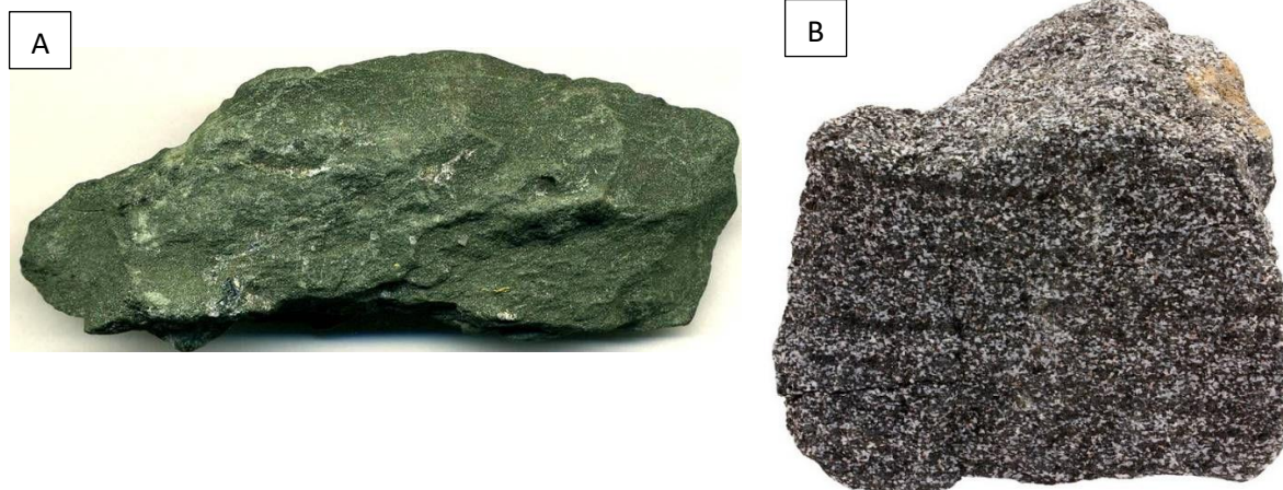
Sl. 53 A) Zeleni škrljavec; B) amfibolit (tamna zrna – hornblenda, bijela zrna – plagioklasi)
