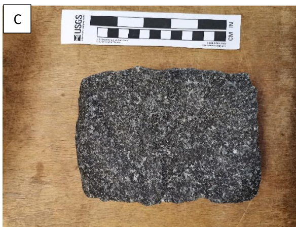
Sl. 22 A) Porfirna struktura (dalenit); B) ofitska-intergranularna struktura (dijabaz); C) zrnata struktura (gabro); D) porfirna struktura (andezit)
