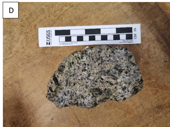
Sl. 22 A) Porfirna struktura (dalenit); B) ofitska-intergranularna struktura (dijabaz); C) zrnata struktura (gabro); D) porfirna struktura (andezit)
