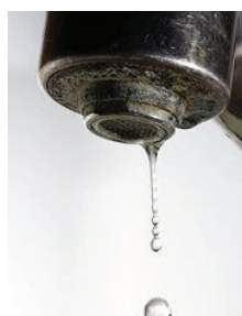
Kalcifikacija otvora cijevi zbog djelovanja tvrde vode
