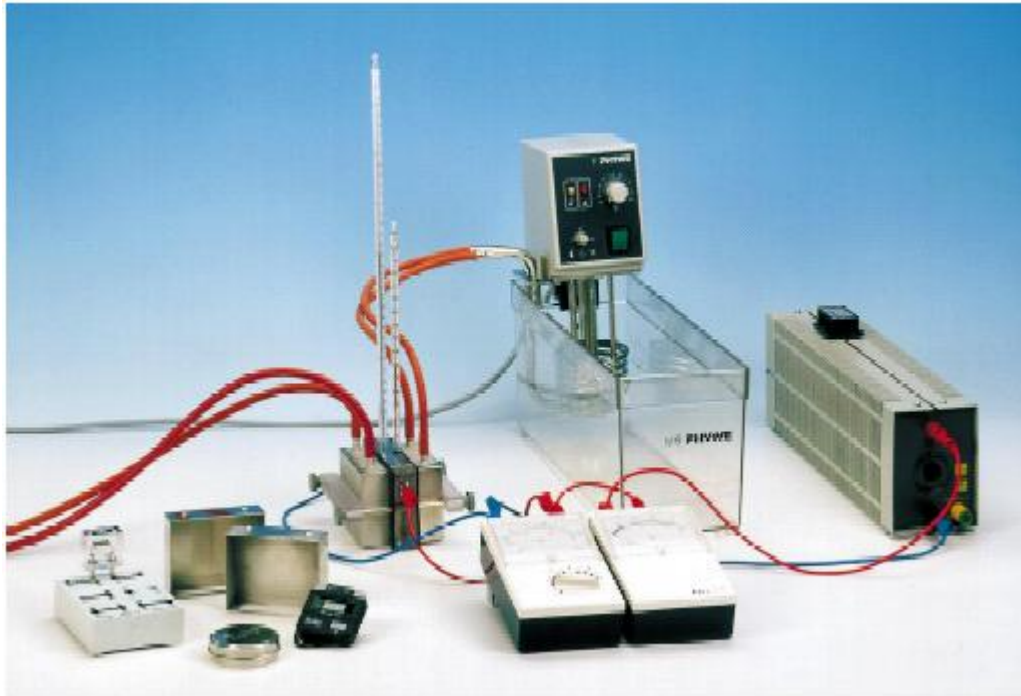
Slika 1: Eksperimentalni postav za mjerenje termonapona i struje kratkog spoja u ovisnosti o temperaturi.
