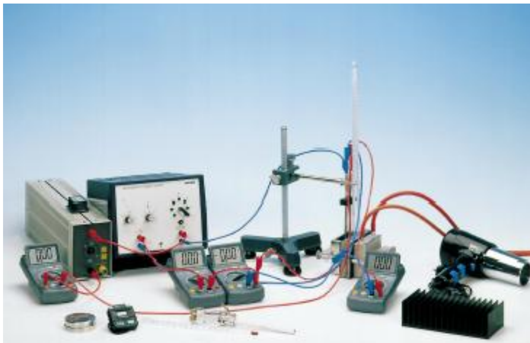
Slika 5: Eksperimentalni postav za mjerenje snaga hlađenja i grijanja Peltierove pumpe.
