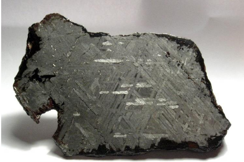
Željezni meteorit (presjek) s Widmanstättenovim figurama
