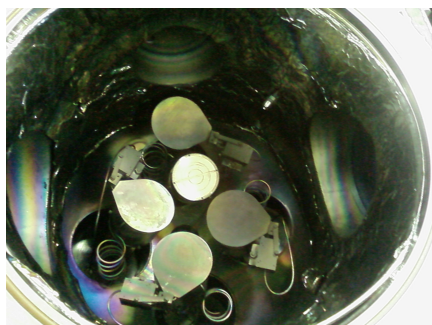
Slika 3: Unutrašnjost vakuumske komore magnetronskog rasprašivača KJLC CMS 18. Vidljiva su četiri magnetrona od kojih je jedan otklopljen (detaljnije u tekstu). Slikano u laboratoriju za tanke filmove Instituta Ruđer Bošković.
