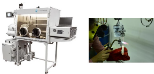
Slika 2: (lijevo) Glovebox sličan onom na IRB u kojem su pomiješani elementi; (desno) proces zatvaranja cjevčice taljenjem krajeva
