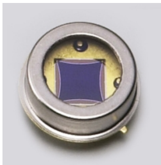
Slika 3: Korištena PiN (foto)dioda. Za potrebe ovog eksperimenta uklonjeno je zaštitno stakalce iznad aktivne površine diode.
