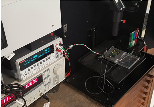
Slika 7: Mjerni postav za mjerenje električne otpornosti dobivenih uzoraka
