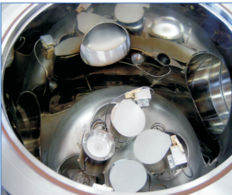
Slika 4: Unutrašnjost KJLC CMS 18 magnetronskog rasprašivača, Laboratorij za tanke filmove (IRB)
