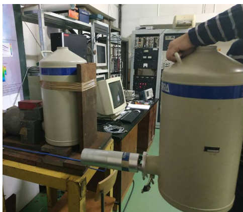
Slika 2: Germanijski detektor zajedno sa spremnikom tekućeg dušika.
