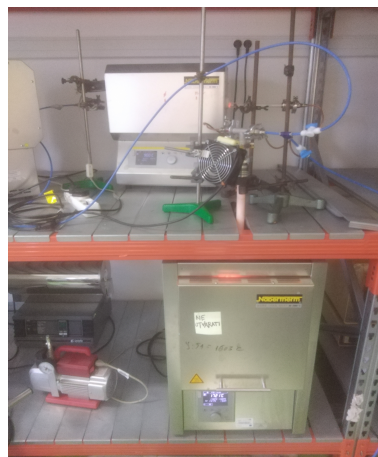
Slika 5: Eksperimentalni postav i peć za sintezu WC
