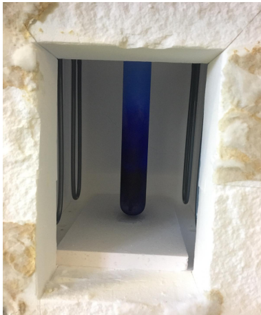
Slika 10: Nastalo kobaltovo modriilo zbog propusnosti cijevi od alumine
