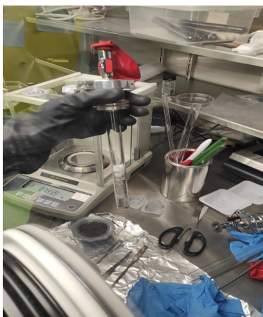
Slika 4: Lončić s uzorkom u kvarcnoj cijevi u gloveboxu
