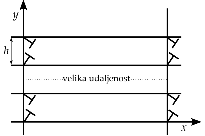
Slika 2. Shematski prikaz dvodimenzionalnog presjeka kristala s dislokacijskim zidovima koji se protežu u beskonačnost u yz ravnini.
