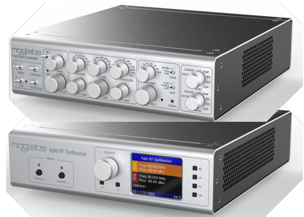
Slika 14. Gore: FSC (brzi servo kontroler), proporcionalni-integralni-derivacijski kontroler (PID). On stvara korektivni signal i šalje ga sintesajzeru. Dolje: Agile RF Synthesizer. On upravlja AOM-om. Unutarnji načini rada ovih uređaja objašnjeni u referencama [18] i [19]. Slike uređaja su preuzete s referenci [20] i [21].
