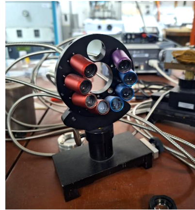
Slika 3: Optički sustav od 8 detektora korišten za prikupljanje emitirane svjetlosti u LIBS postavu.
