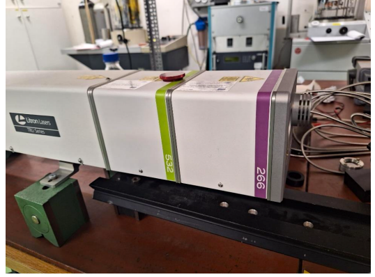
Slika 2: Nd:YAG laser korišten kao izvor svjetlosti, zajedno s dva harmonička modula koji generiraju više harmonike.
