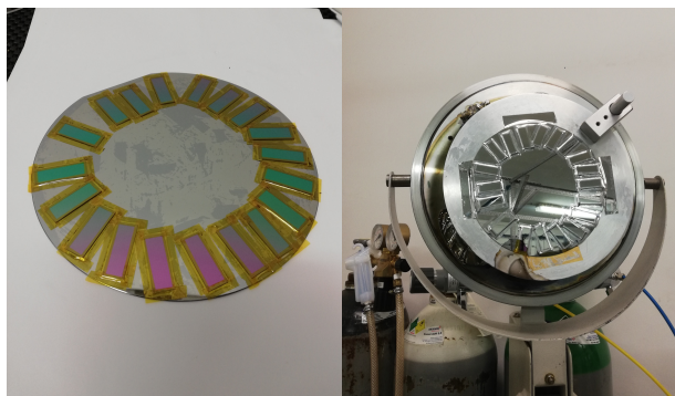
Slika 9. Pločice Si/SiO 2 supstrata prije (lijevo) i poslije evaporacije aluminijske.
