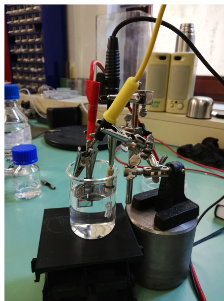
Slika 10. Eksperimentalni postav za provođenje procesa anodizacije.
