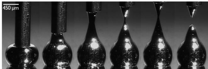
Slika 17. Formacija mikrokapljica koristeći EGaIn. Preuzeto iz 22.
