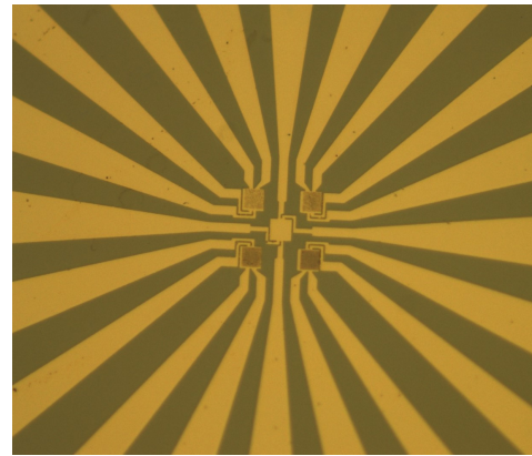
Slika 2. Četiri uzorka od kojih je svaki uzorak nanostruktura zlata prekrivena mrežom tankog filma niobija određene popunjenosti. Popunjenost uzorka: gore lijevo - 20%, gore desno - 30%, dolje lijevo - 40%, dolje desno - 50%.
