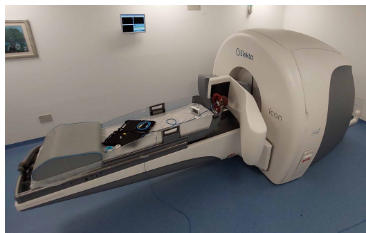
Slika 1. Leksellov gama nož s fantomom i ionizacijskom komorom. Ruka CBCT-a nalazi se u spušenom položaju.
