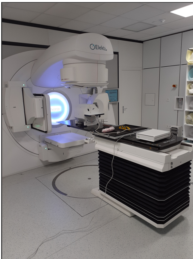
Slika 3. Eksperimentalni postav za predaju i mjerenje radioterapijskim planovima propisanih raspodjela doze smješten u sobi za provedbu radioterapije. Na slici se mogu vidjeti glavne komponente postava koje uključuju Elekta Agility linearni akcelerator, PTW Octavius II fantom s umetnutim PTW Octavius Detektor 1500 i Detector Interface 4000 elektrometar.
