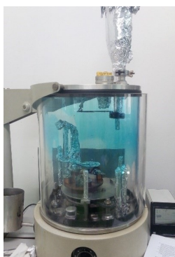
Slika 15: Korištena komora za termalnu evaporaciju
