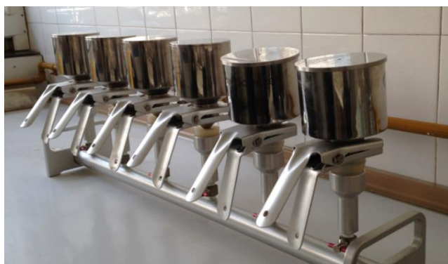
Slika 1. Sustav za membransku filtraciju Fig. 1. Membrane filtration system
