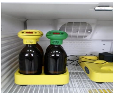
Slika 5. Uređaj za određivanje vrijednosti BPK_5 - WTW OxiTop® IS 6
