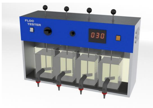
Slika 3. Uređaj za ispitivanje modificirane koagulacije
