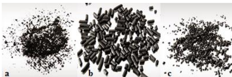
Slika 3. Vrste aktivnog ugljena: (a) praškasti, (b) peletirani, (c) granulirani (www.norit.com)
