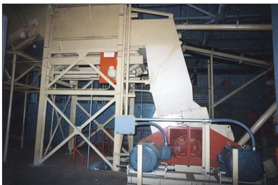
a) mehanička obrada – usitnjivač
