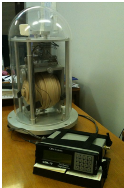
Slika 2: Primjeri instrumenata, lijevo: apsolutni instrument, GEM GSM-19 (Overhauser); desno: relativni instrument, GEM dIdD.
