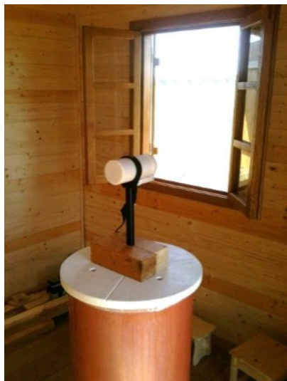
Slika 2: Primjeri instrumenata, lijevo: apsolutni instrument, GEM GSM-19 (Overhauser); desno: relativni instrument, GEM dIdD.
